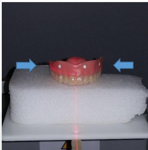
Posicione a **prótese** no tomógrafo para que fique centralizado no sentido **lâtero-lateral**. Para que toda a prótese seja incluída na TC.
