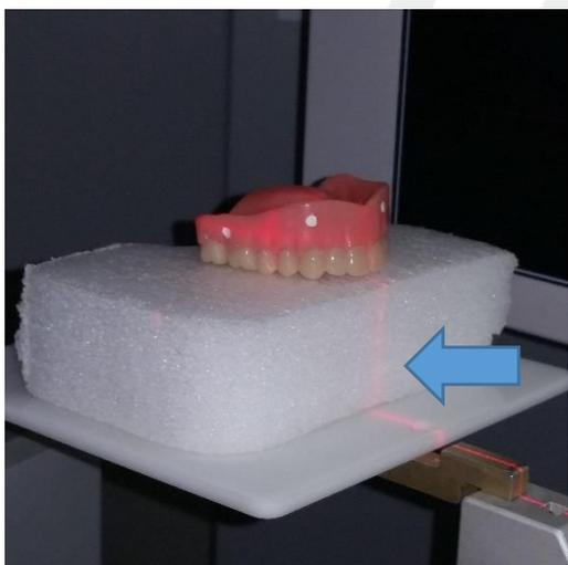
Coloque a **prótese** no aparelho, use uma base de isopor para ajudar na posição e **evitar os artefatos** da estrutura do tomógrafo
