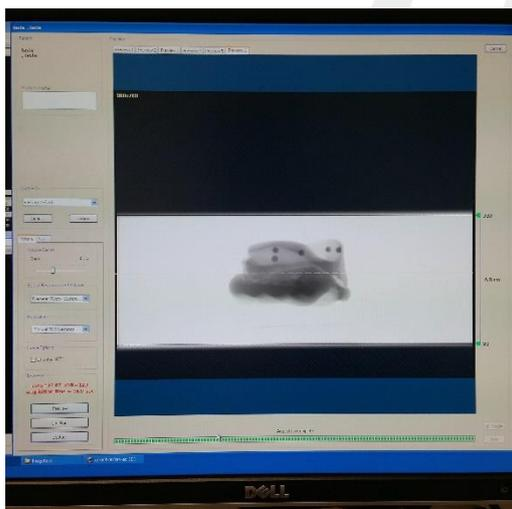
Realize a aquisição da imagem seguindo o protocolo do seu tomógrafo. Em seguida grave as imagens **axiais** em formato DICOM.
