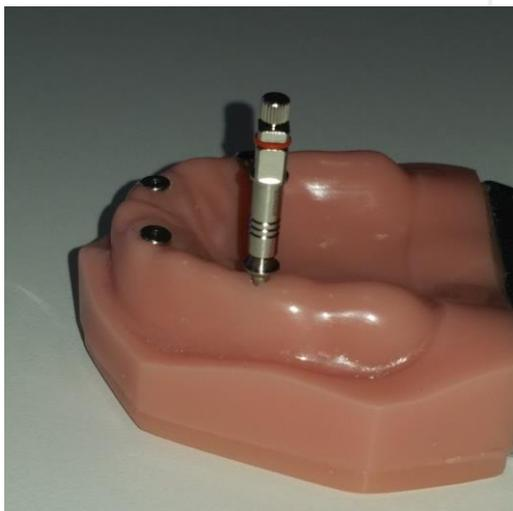
Com uma chave de instalação de minipilar, rosqueie manualmente até sentir uma resistência, então use a catraca para dar 30N de torque.
